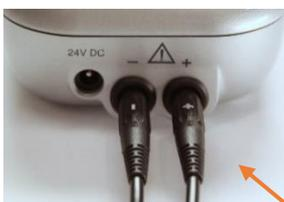
An der linken Außenseite des idromed® 5 GS befinden sich die Steckeranschlüsse für die Elektrodenkabel.
